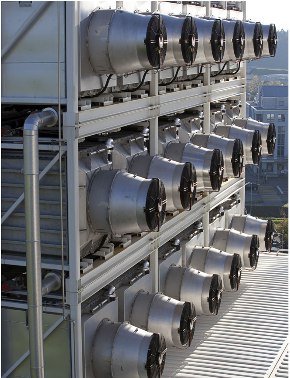
Zwitserse proefopstelling om CO 2 uit de lucht te filteren. Door CO 2 uit de lucht te halen en te hergebruiken kunnen zelfs negatieve emissies ontstaan.
